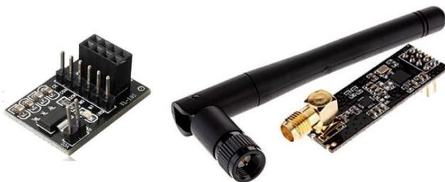
Figura 5. Módulo NRF24L01+ con antena externa y módulo adaptador de voltaje.
