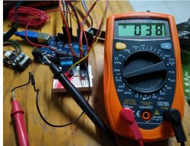
**Figura 16.** Medición de consumo energético del prototipo.
